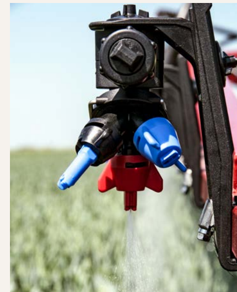
Tre olika munstycken på en tripplett där munstycken snabbt växlas manuellt på sprutrampen.
