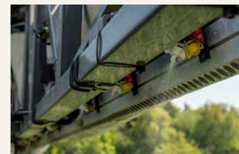
Pulserande munstycken ger god precision genom att kunna variera vätskeflödet vid konstant tryck, ca 3 bar. Droppkvaliteten behålls konstant, oavsett om du kör i 4,5 km/h eller 11 km/h. Detta ökar effekten och minimerar vindavdrift.
