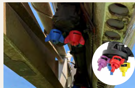
Med Autoselect på sprutan kan två munstycken växlas under körning. Antingen manuellt eller automatiskt genom ändring av tryck och /eller hastighet. Finns även som Autoselect Duo.
