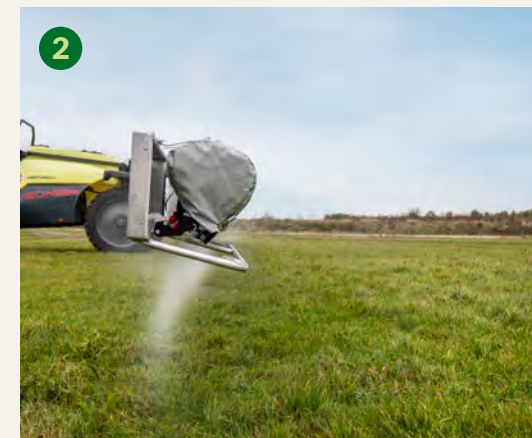
Utan luftassistent (1) och med luftassistent (2) för minskad vindavdrift, bättre täckning och därmed god behandlingseffekt.
