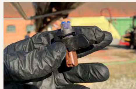
En del produkter har krav på avdriftsreducerande utrustning, t.ex. 50, 75 eller 90 % minskad vindavdrift från munstycket.
