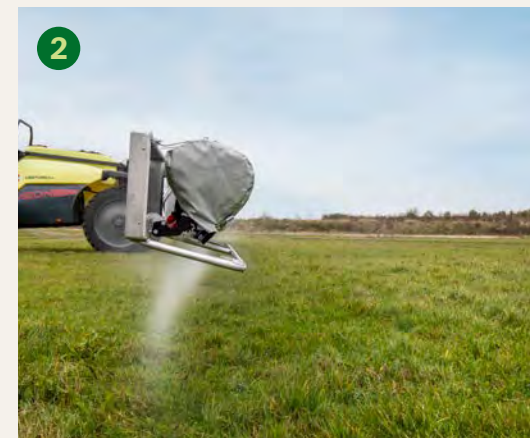
Utan luftassistans (1) och med luftassistans (2) för minskad vindavdrift, bättre täckning och därmed god behandlingseffekt.
