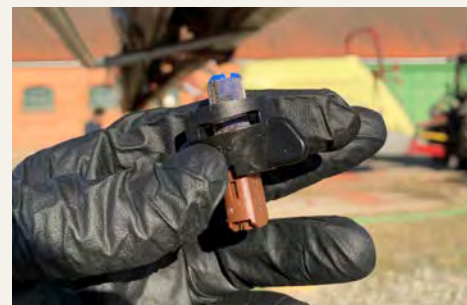
En del produkter har krav på avdriftsreducerande utrustning, t.ex. 50, 75 eller 90 % minskad vindavdrift från munstycket.
